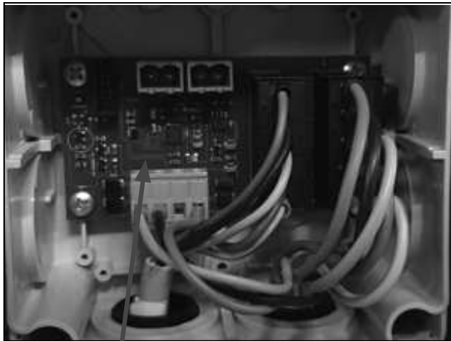
(DE) Abbildung 19 – Sensorplatine (FR) Figure 19 – Carte capteur (EN) Figure 19 – Sensor board (IT) Figura 19 – Scheda sensore (NL) Afbeelding 19 – sensorprintplaat (ES) Figura 19: Circuito impreso del sensor (SV) Bild 19 – sensors kretskort (DA) Ill. 19 - sensorprintkort (FI) Kuva 19 – Anturikortti (PL) Rysunek 19 – Płyta czujnika (RU) Рисунок 19. Плата датчиков
